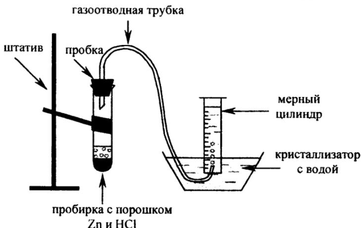
В пробирке начинается выделение водорода, который по трубке поступает в мерный цилиндр и вытесняет из него воду. Объем вытесненной воды равен объему полученного водорода ( $V_{H_2(\text{практ.})}$ ).
